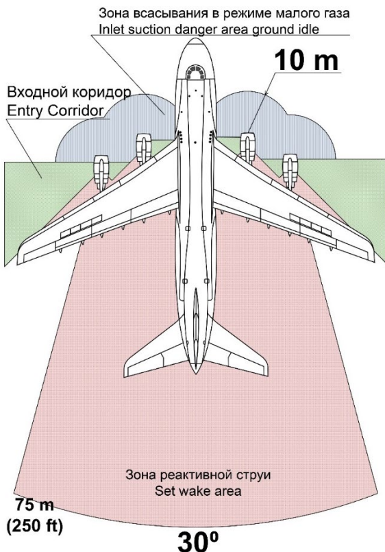
Рисунок 1. Опасные зоны Ан-124-100 (-150) при работе двигателей на режиме малого газа
